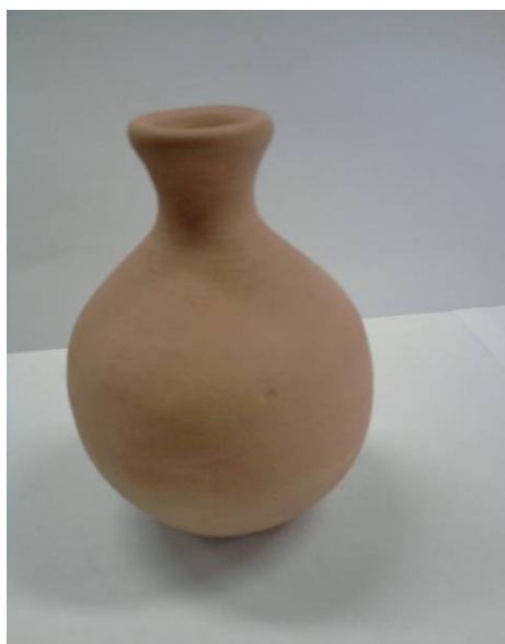
Figura 4 - Amostra sinterizada confeccionada com massa cerâmica com incorporação de 15% de lodo seco e moído.
