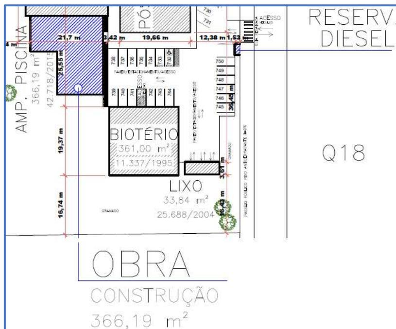
**1.3 – Porta de acesso principal:** a obra licitada será uma ampliação de um prédio existente, no qual há uma porta para o exterior. No projeto arquitetônico, o acesso da edificação existente para a edificação ora licitada é assim representada:
