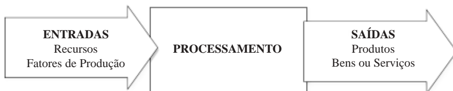
Figura 1 – Esquema simplificado dos elementos de um sistema produtivo
