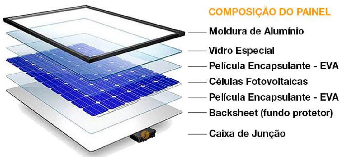
Figura 3 – Composição do painel fotovoltaico.
