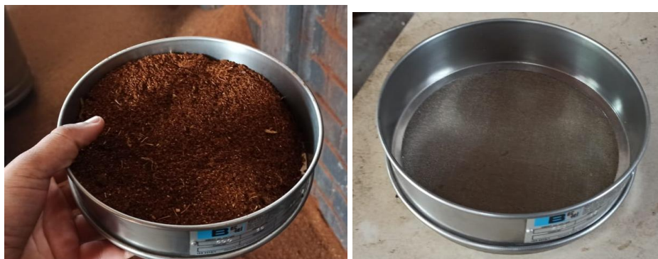
Figura 41: Peneiras granulométricas para extração de informações do farelo e torta da torta de canola em relação a variação da temperatura e rotação.
