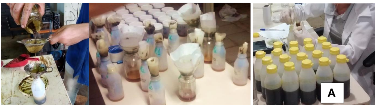
Figura 7: Óleo de canola por prensagem a frio, processo de filtragem e separação. Fonte: Autor (2019)
