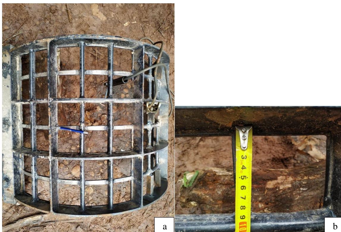
Figura 18 a - Grelha de Picador de Cavaco de Lenha, b -- Dimensões da Grelha do Picador. Fonte: O autor (2020).
