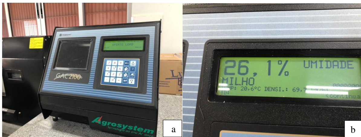
Figura 9 a - Medidor de Umidade de Grãos, b - Dados da Umidade. Fonte: O autor (2020).
