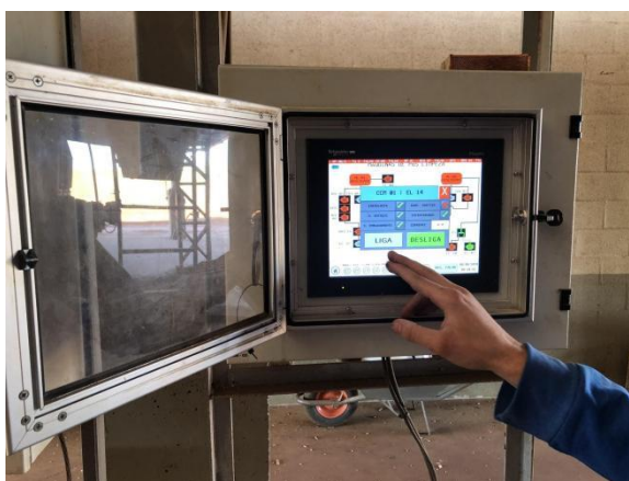
Figura 17 - Controlador de Temperatura e Alimentação do Queimador de Cavacos. Fonte: O autor (2020).
