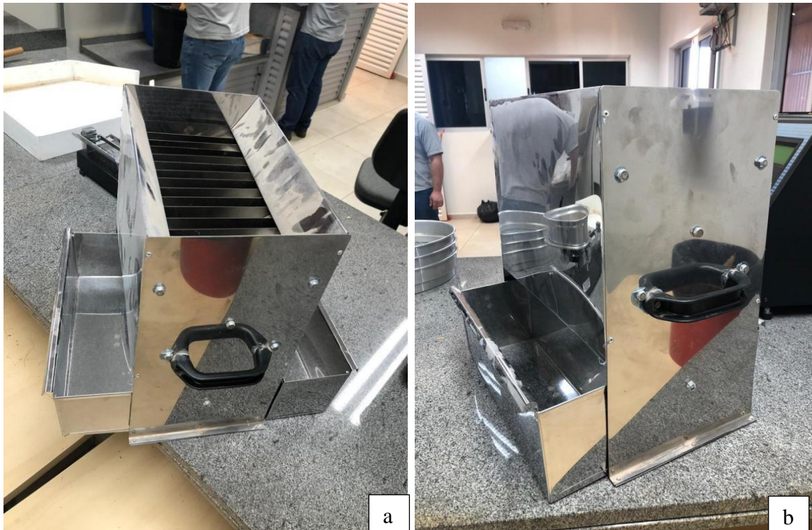
Figura 11 a e b - Homogeneizador de Amostras Tipo Quarteador. Fonte: O autor (2020).
