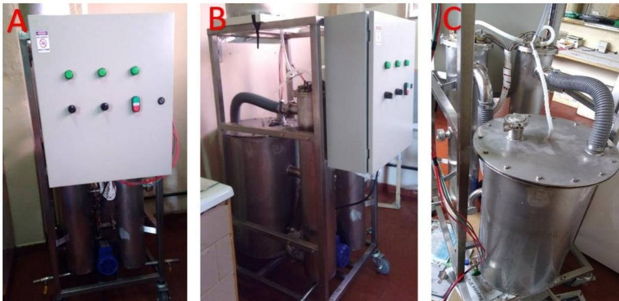
**Figura 8.** Reator com radiação ultravioleta (a: quadro elétrico; b: reator completo; c: tanque de armazenamento).
