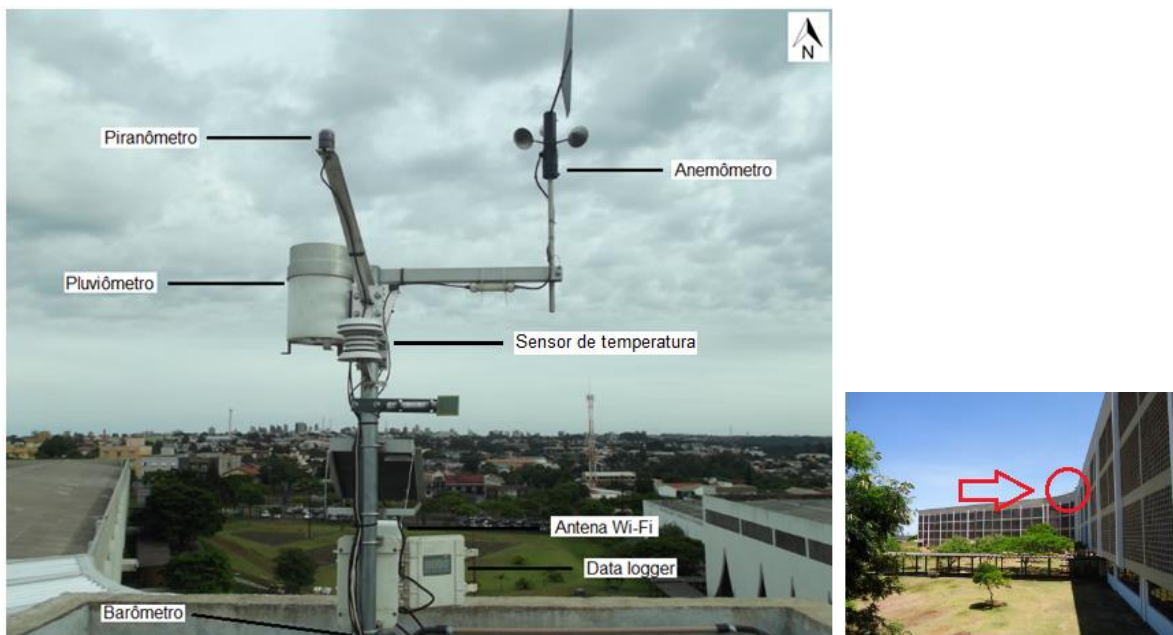
Figura 30: Estação meteorológica Hobo U30 Station Wi-Fi e localização do equipamento acima do prédio. Fonte: Elaborado pelo Autor.
