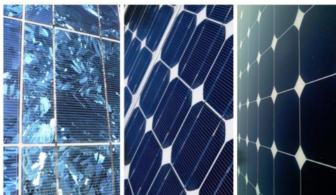
Figura 12: Tecnologia fotovoltaica tipo policristalina, monocristalina e amorfo, respectivamente.
