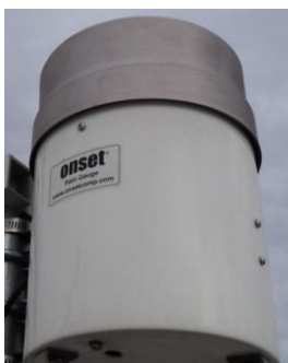
Figura 36: Sensor pluviométrico MAN-S-RGX. Fonte: Autor.
