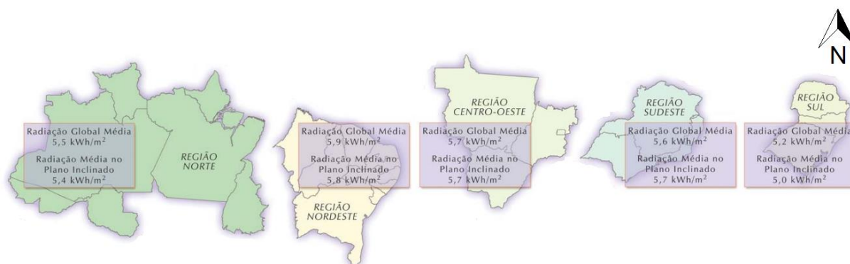
Figura 07: Vista explodida das regiões brasileiras, com valores do potencial interanual médio disponível pela energia solar em cada região. Fonte: Adaptado de (PEREIRA, 2006).
