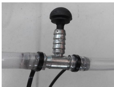
Figura 9. Conexão em T, utilizada para coleta e saída de gás.
