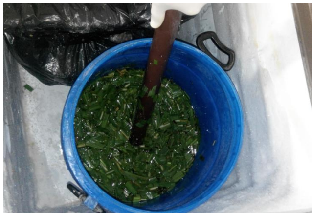
Figura 5. Pré-tratamento da palha com Ureia e NaOH
