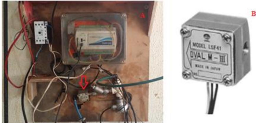
**Figura 8.** (A) Posicionamento do fluxômetro no experimento; (B) Modelo do fluxômetro utilizado no experimento.
