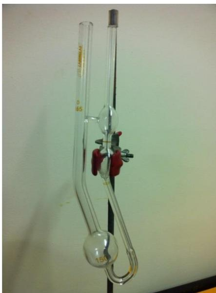
**Figura 5.** Cannon-Fenske utilizado para medição da viscosidade das amostras. Fonte: Acervo do autor.
