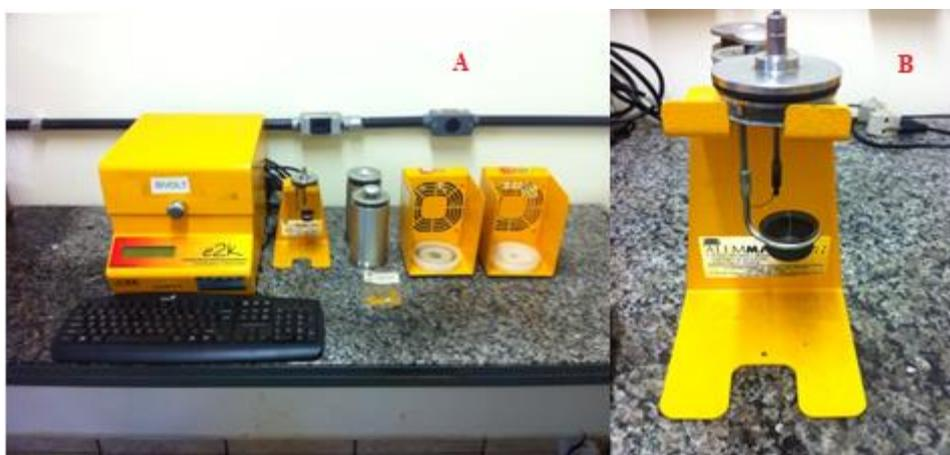
**Figura 4. (A)** Equipamento e2k para medição do Poder Calorífico Superior (PCS); **(B)** Cadinho metálico e fio de algodão preso à resistência.
