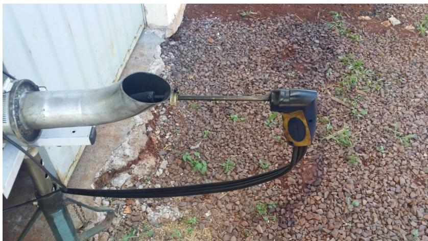
**Figura 14.** Inserção do detector de gases do Bacharach para medição do SO<sub>2</sub> na saída do motor.
