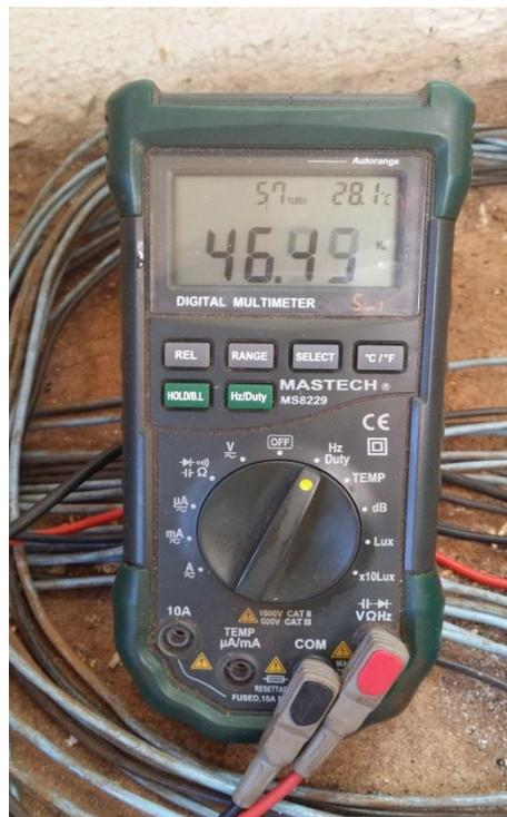
**Figura 12. Multímetro para medição da frequência do conjunto motor-gerador.**
