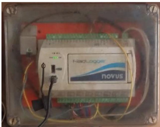
**Figura 10.** Datalogger FIELDLOGGER para aquisição e registro dos dados.
