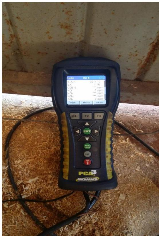
**Figura 13.** Equipamento para mensuração dos gases de escape, marca Bacharach. Fonte: Acervo do autor.
