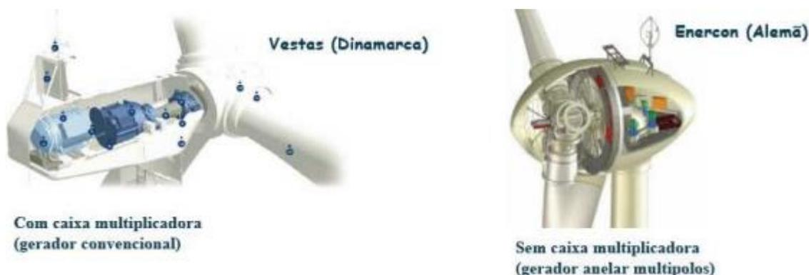
**Figura 5** – Nacele com e sem caixa multiplicadora
