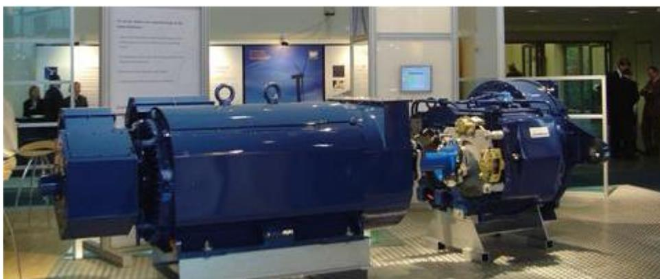
**Figura 7** – Gerador conectado a caixa de engrenagens (vista à direita).
