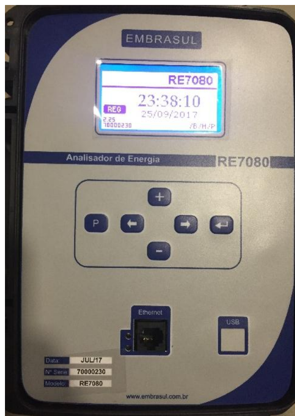
Figura 15. Analisador de energia Embrasul RE7080.
