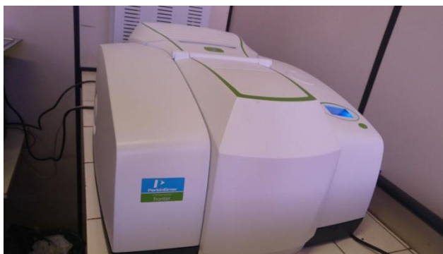
Figura 31 – Equipamento de FTIR, Modelo PerkinElmer – Spectrometer Frontier Fonte: Aatoria Própria (laboratório de Química da Unioeste – Campus Toledo)
