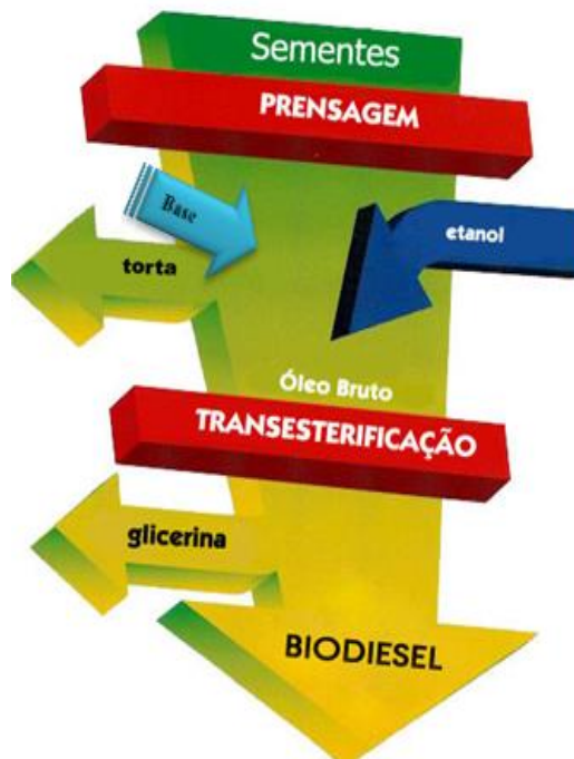
Figura 09 - Esquema simplificado da produção de biodiesel. Fonte: Adaptado de biodiesel BR (2013).
