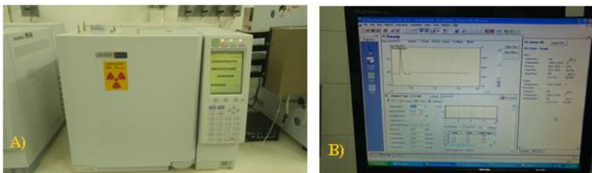
Figura 32 – A: Equipamento de CG, Modelo SHIMADZU – GC 2010. B: Monitor com as bandas de detecção do gás em análise. Fonte: Aatoria Própria, Laboratório de Engenharia Agrícola – Unioeste, Campus Cascavel.
