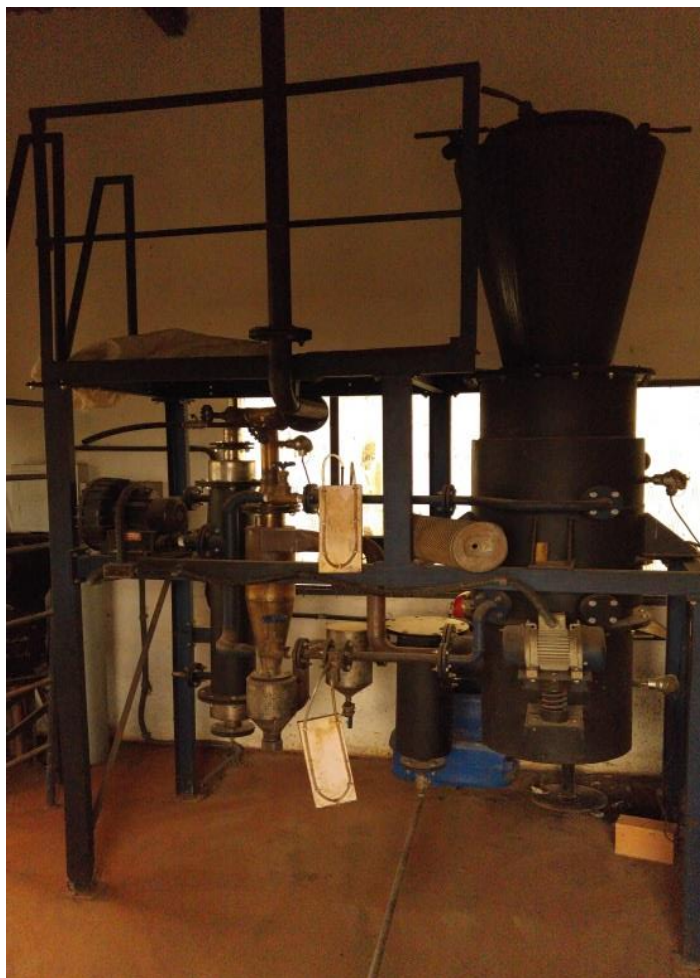
Figura 29 – Unidade de gaseificação. Fonte: Autoria própria. (laboratório Bionergia da Unioeste – Campus Cascavel)
