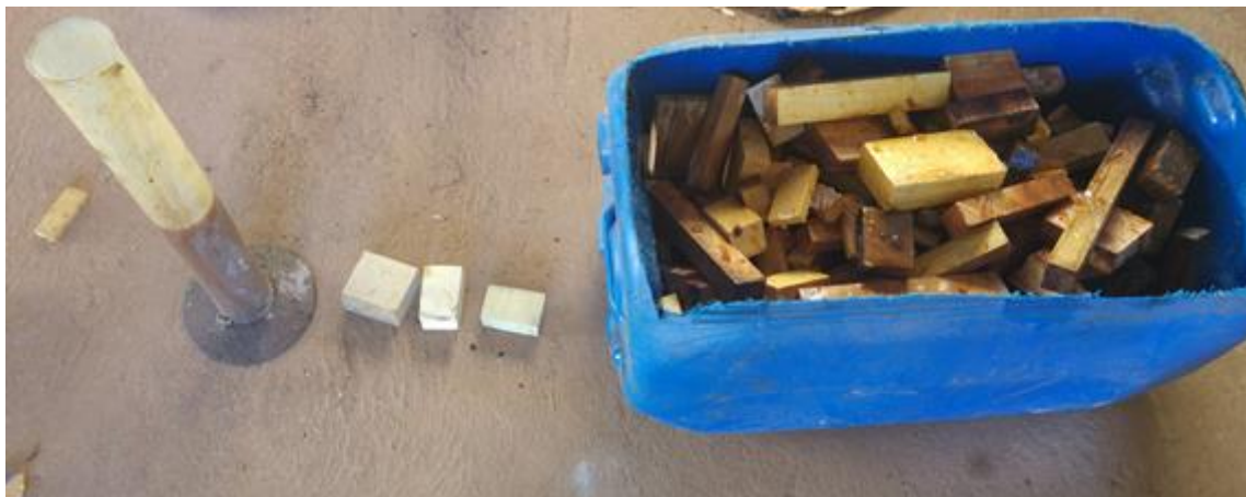
Figura 36- Mistura Madeira (Pau-Marfim) e Glicerina Fonte: Autoria própria (laboratório Bionergia da Unioeste – Campus Cascavel)
