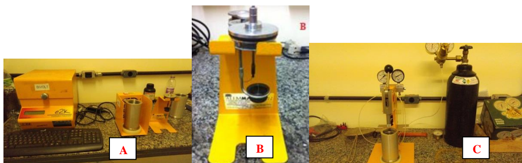
Figura 25 - Equipamento e2k para medição do PCS. A- Bomba Calorimétrica B - Cadinho metálico e fio de algodão preso à resistência. C – Estação de carga
