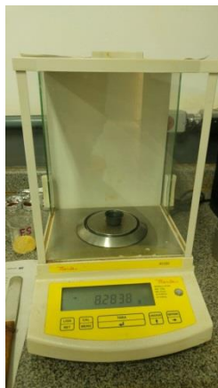
Figura 26 – Balança (Marte AY220) com 04 casas decimais Fonte: Autoria Própria (laboratório de solos da Unioeste – Campus Cascavel)
