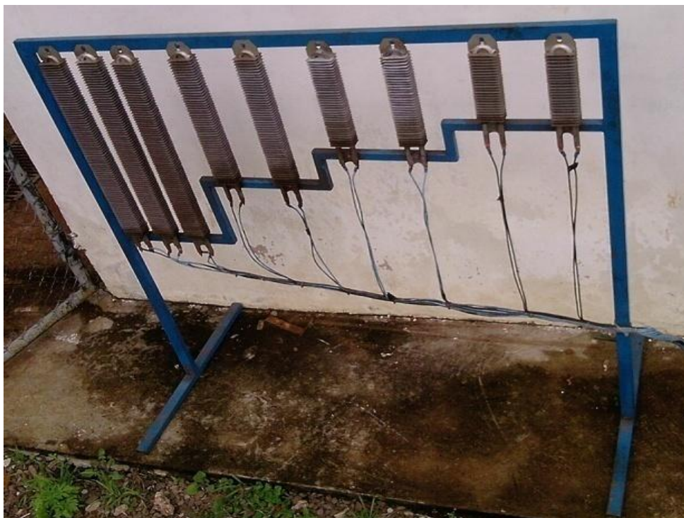
Figura 9 – Banco de resistências.
